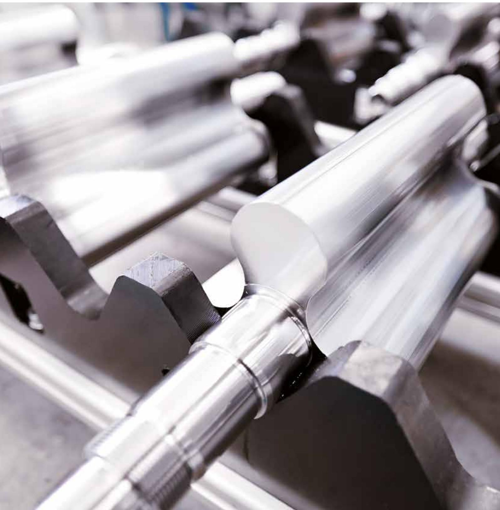
*Роторные воздуховуки AERZEN – это высокотехнологичная продукция. Производимая на современных станках с ЧПУ. Для обеспечения минимальных отклонений между компонентами и исключительно высокого уровня эффективности. Достигая точности. Сделано AERZEN.*
