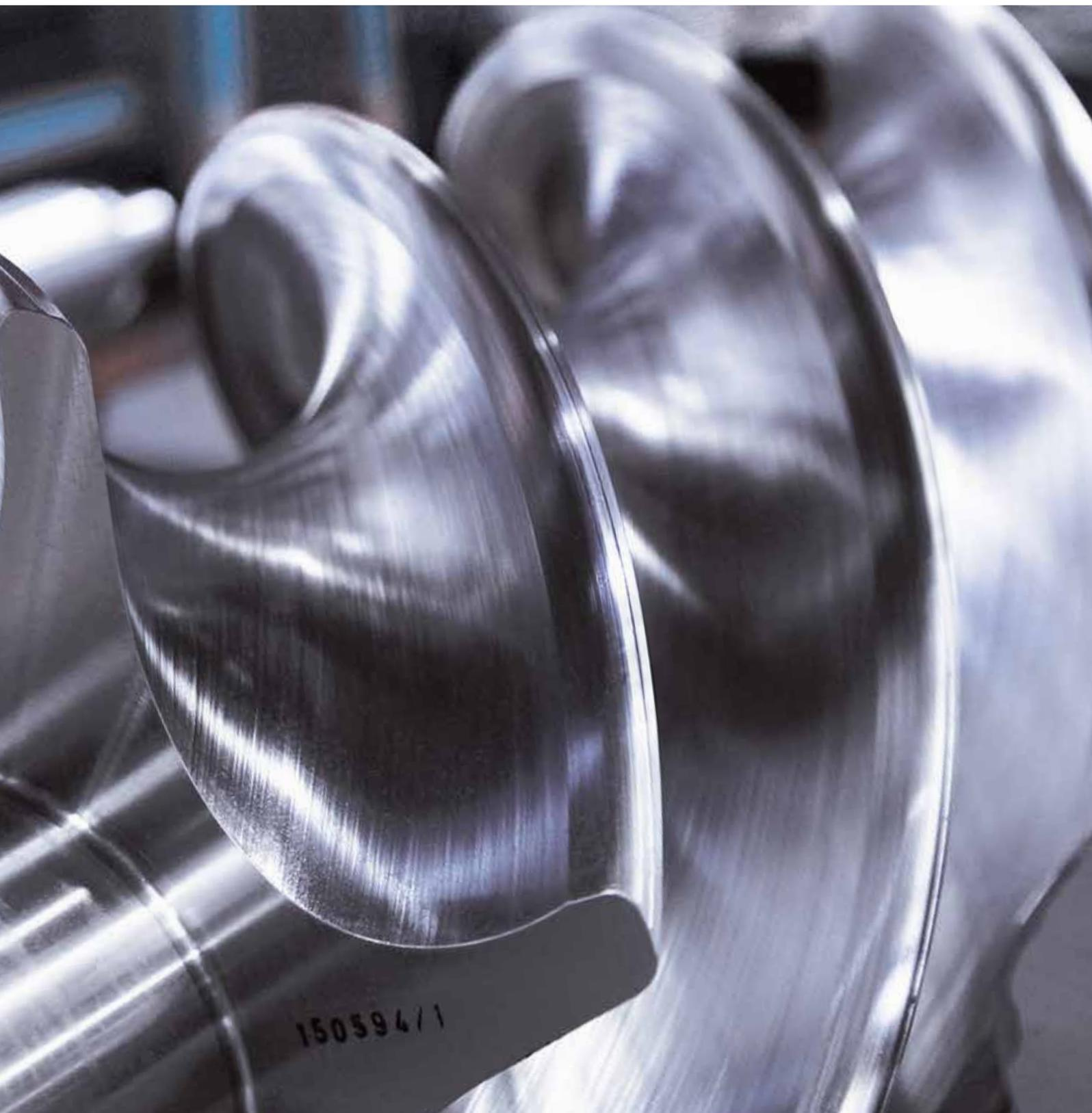
*Винтовые компрессоры AERZEN характеризуют специальные профили винтов, которые обеспечивают значительно лучшую производительность в эксплуатации с избыточным или отрицательным давлением.*
